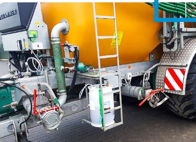
↑ Die Zudosierung von Vizura® funktioniert mit verschiedenen Systemen. Für die Dosierung eignen sich Pumpen unterschiedlicher Hersteller. Wichtig dabei ist, dass die Pumpsysteme säurebeständig sind und mit Phosphorsäure kompatibel.
